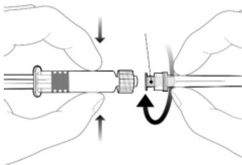
Pour fixer l'aiguille, connecter l'embase de l'aiguille sur l'adaptateur Luer Lock et tourner d'un quart de tour dans le sens des aiguilles d'une montre jusqu'à sentir un blocage.
