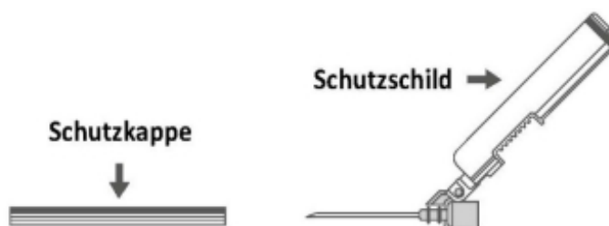
Abbildung D: Bestandteile der Sicherheitskanüle (für den Gebrauch vorbereitet)
