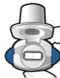
Kontrollieren Sie, ob die Kapsel entleert ist. Öffnen Sie den Inhalator, um zu sehen, ob noch Pulver in der Kapsel verblieben ist.
